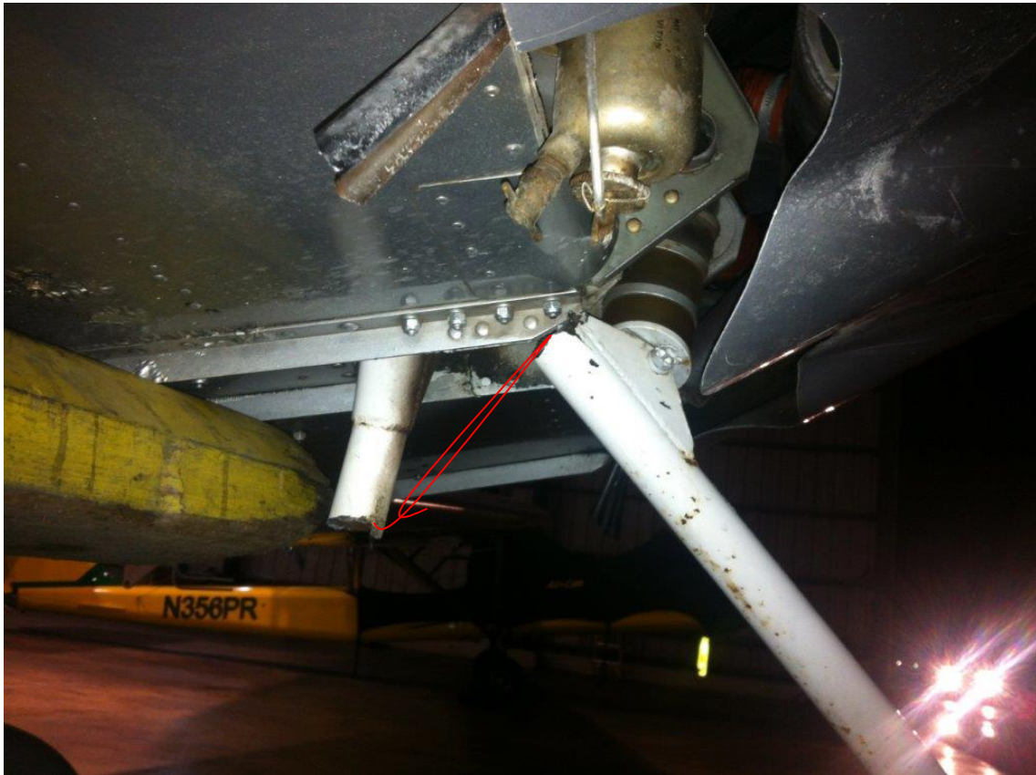
Vista de la rotura del tren.
