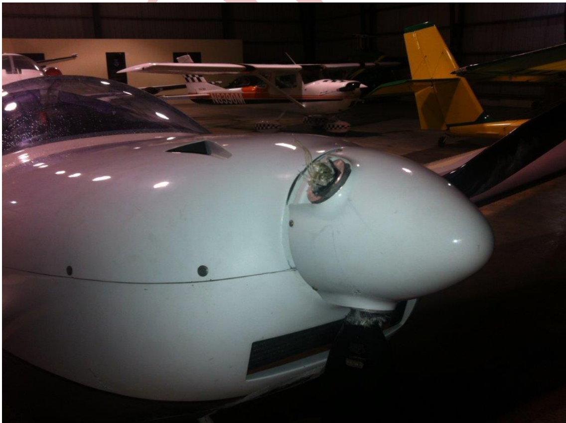
Nótese la rotura de una de las aspas
